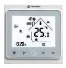
Питание / Частота: 230 В АС / 50 – 60 Гц Максимальный ток: 5 А Рабочая температура: 0 - 45°С Диапазон регулировки: 5°С - 35°С Точность регуляции: ± 0,5°С Внешний датчик температуры: NTC 10К Стандарт передачи данных (ВМS): RS485 Размеры: 86 x 86 x 13,3 мм Вес: 270 г Степень защиты (корпус): IP 20 Степень защиты (внешний датчик): IP 68
